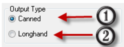
Рисунок 25 Варианты вывода сверлильного цикла 1 – укороченный, 2 – полный
